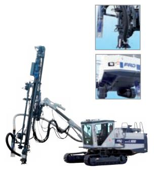
Poderoso equipamento Top Hammer, pode ser utilizado em aplicações em pré corte, produção, extração seletiva, despressurização de rochas e pedreiras, até uma profundidade de 26 metros. Há também uma opção de uma versão para uso com passagem única com hastes de 6 metros.
