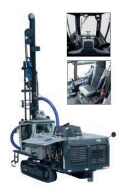
É o modelo Top Hammer mais potente, podendo ser utilizado para aplicações e pré-corte, produção, extração seletiva, despressurização de rochas e pedreira, até uma profundidade de 30 metros.
