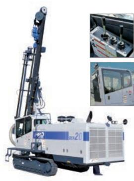
Equipamento de perfuração ideal para bancada e pré-corte. Equipamento robusto, durável e de fácil manutenção. Excelente produtividade com baixo consumo de combustível. Possui IMS, sistema que monitora o estado do equipamento e auxilia tanto o operador quanto o mecânico na resolução de problemas, reduzindo o tempo de reparo. Cabine selada ROPS/FOPS, controles confortáveis por joystick e assento ergonômico para conforto do operador.
