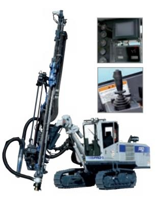
Modelo mais versátil de perfuração Top Hammer, com capacidade para utilizar hastes T45 e T51. Cabine selada ROPS / FOPS com ar condicionado e filtro de ar que evitam a entrada de poeira.
