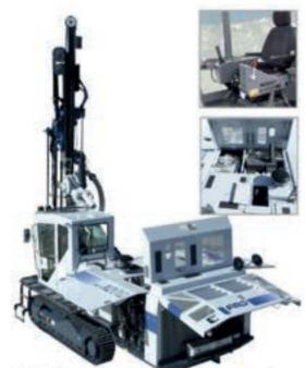
Modelo Top Hammer de alta potencia, podendo ser utilizado em aplicações de pré-corte e produção na mineração ou perfuração em obras de infraestrutura, até profundidades de 26 metros. Existe também uma versão deste modelo para uso single pass com hastes de 6 metros de comprimento. Possui sistema IM5, que monitora as condições do equipamento e auxilia o operador/mecânico a solucionar problemas técnicos, reduzindo o tempo de parada para manutenção.
