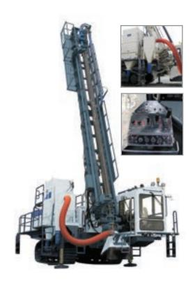
Unidade de potência encorpada, que garante maior durabilidade aos componentes principais. Painel de controle simples e controle digital dos parâmetros de perfuração.
